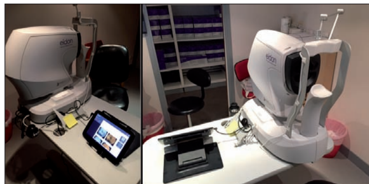
Figure 1. Rétinographe SLO Eidon commandé à partir d'une tablette tactile.
